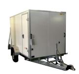
**Brühlmann MOS Ho** Alu-Sandwichaufbau weiss 25 mm mit eloxierten Aluprofilen, Hubdeckel mit Gasdruckfedern mit inliegendem Drehstangenverschluss abschliessbar, hinten Alurampe Tragkraft 1600 kg Rampenhilfe, innen 50 cm hoch verstärkt Airlineschienen beidseitig montiert, Siebdruckboden mit 3 versenkten Airlineschienen mit je 3 verstellbaren Haltepunkten, extra tiefe Ladefläche,
