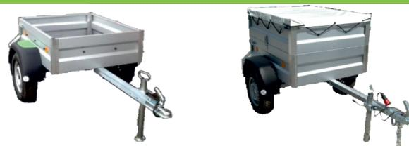
**Brühlmann Geschützte Werkstatt** ungebremst, Siebdruckboden, verzinktes Blech hinten Klappe, Stütze, Hochplane + Gestell montiert
